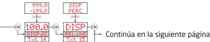
1.0 = Estado de defecto. La línea 1 muestra el estado de la entrada, la línea 2 muestra el valor de la entrada y el numero TAG NO. La línea 3 muestra el valor de salida y las unidades. La línea 4 muestra el estado del relé y de comunicación y cuando el modulo esta bloqueado para aplicaciones SIL. Punto estatico = Bloqueo de SIL y punto parpadeando = NO bloqueo de SIL.
